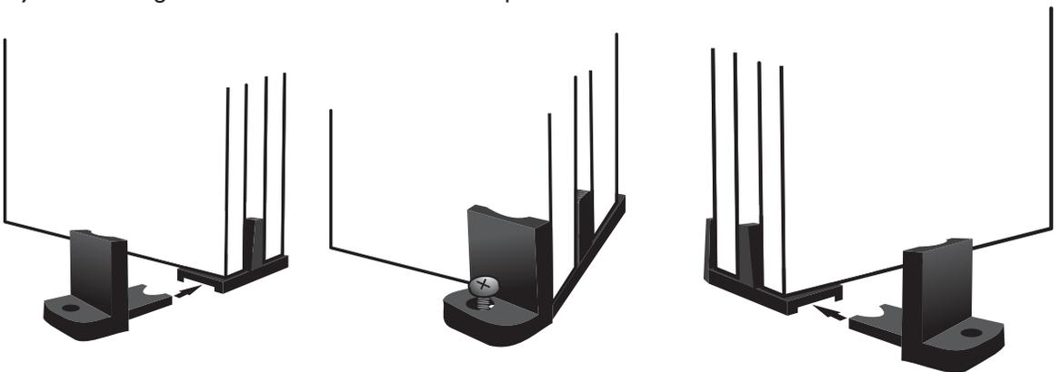
b) Ubique el centro en el borde de la parte interna de la puerta y ajuste el freno como se muestra en la ilustración
